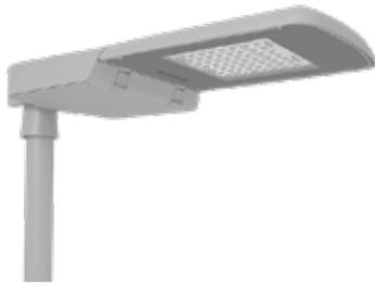
RACER MINI ist ein schlanker LED-Flutlichtstrahler für die Straßen- und Stadtbeleuchtung und zur Montage an Masten mit einem oberen Zopf-Durchmesser von 48-60 mm geeignet. RACER MINI wird mit einem Leuchtengehäuse aus Aluminiumdruckguss mit einer Polyester-Pulverbeschichtung hergestellt. Die Optik besteht aus Linsen-Panels. Der Flutlichtstrahler wird mit einer Abdeckung aus gehärtetem Sicherheitsglas geliefert.
