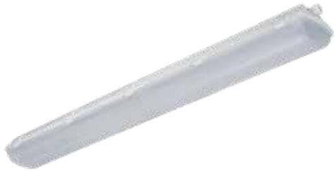
Glamox iG66 ist eine staubdichte und strahlwassergeschützte Leuchte, die sich durch ihre Schutzart-Eigenschaften für eine Reihe von anspruchsvollen Bereichen und Räumen eignet. Die Leuchte besteht aus recycelfähigem Polycarbonat, mit Wannenschlüssen und Montageklammern aus Edelstahl. Die iG66 kann einfach an Decke, Wand oder Tragschiene montiert werden. Die Leuchte verfügt über eine robuste, satinierte Polycarbonatabdeckung. Die Leuchte ist mit Highpower-LED's ausgestattet.
