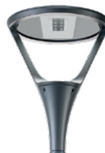
Glamox O41 ist eine dekorative 4 bis 6 m hohe LED-Mastleuchte. Geeignet für die Beleuchtung von Parks, Wege und Anlagen. Die Leuchte kann mit einer Halterung an der Wand montiert werden. Erhältlich in drei Farben: schwarz, anthrazit oder aluminiumgrau. Die Leuchte ist mit drei Arten von Optiken erhältlich: breitstrahlend (WB), asymmetrisch breitstrahlend für Wegbeleuchtung (WBA) und asymmetrisch tief-/breitstrahlend (MBA).
