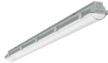
COSMO APEX ist eine robuste Leuchte, die sich für eine Vielzahl von Anwendungen eignet. Der Diffusor und das Leuchtengehäuse bestehen aus recycelbarem, selbstverlöschendem, UV-stabilisiertem Polycarbonat mit Montagehalterungen und Diffusorclips aus Edelstahl. COSMO APEX lässt sich leicht an der Decke oder der Wand montieren. Die Leuchte kann auch mittels Abhänger abgedreht werden. Für Innen- oder Außenbereiche (in geschützten Bereichen, wie z.B. unter Vordächern).
