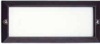
MINI GAMMA ist eine Leuchte für den Wandeinbau. Hervorragend geeignet für den Einsatz in Treppenhäusern zur Stufenbeleuchtung, wo ein hohes Maß an Sicherheit gefordert ist. Erhältlich in verschiedenen Ausführungen. Das Leuchtengehäuse der MINI GAMMA besteht aus Aluminium-Druckguss. Schwarze Polyester-Pulverbeschichtung. Die Abdeckung besteht aus opalem, gehärtetem Glas. Das Einbaugehäuse aus Techno-Polymer wird mitgeliefert.
