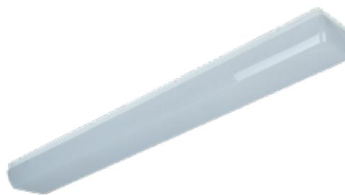
iG200 ist eine LED-Wannenleuchte im klassischen Design mit abgeschrägten Kanten und erhöhter IP-Schutzart. Das Gehäuse besteht aus UV-beständigem, weißem Polycarbonat. Die Leuchte wird mit opaler UV-beständiger Polycarbonat-Wanne geliefert. Durch die Verwendung von Polycarbonat als Gehäuse- und Wannenmaterial ist die Leuchte sehr schlagfest und robust. Mit der erhöhten IP-Schutzart durch die Polyurethan-Dichtung ist die iG200 LED ideal für den Einsatz in Feuchträumen geeignet.
