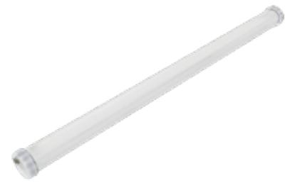
Glamox i25 ist eine schlanke und robuste IP68-Leuchte (bis zu 20 Meter Tiefe) für Industrie- und Außenanwendungen. Durch die schlanke Konstruktion ist die Leuchte sehr platzierungsfreundlich und hervorragend für Anwendungen mit nur wenig Raum für die Montage geeignet. Das Leuchtengehäuse der i25 besteht aus extrudiertem klaren oder opalen Polycarbonat mit Endkappen aus weißem Polycarbonat. Die Leuchte wird mit Leuchtmitteln und einer vormontierten Leitung geliefert.
