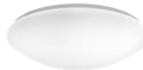
Zeitloses Design in sphärischer Form. Dieses Produkt ist mit einem Mikrowellensensor mit relaisbasiertem An-/Aus-Schalter SMR-SEN (Bewegungsmelder) erhältlich. Tiefgezogenes und verwindungssteifes Stahlblechunterteil, weiß pulverbeschichtet. Bajonettverschlüsse sorgen für einen sicheren Halt und eine einfache Montage der Abdeckung.
