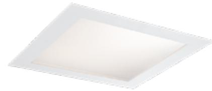
C70-R G2 ist eine flexible Leuchte zur Deckenmontage. Sie verfügt über einen sichtbaren Rahmen, welcher der Leuchte einen einzigartigen, klaren Ausdruck verleiht. C70-R G2 ist gut geeignet für alle 15 und 24 mm T-Profil Decken. Für andere Deckenarten, wie z.B. Gipskarton- und verdeckte Decken, ist ein Montagerahmen mit Halterungen als Zubehör erhältlich. Eine externe Betriebsgerätebox wird mit der Leuchte geliefert. Anschluss und Wartung erfolgt ohne Öffnen der Leuchte.
