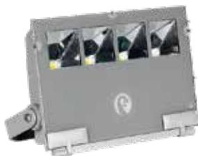
NEXT ist eine dekorative Strahler-Serie für den Außen- und Innenbereich mit einer symmetrischen oder asymmetrischen Lichtverteilung. NEXT verfügt über ein Leuchtgehäuse aus Aluminium-Druckguss mit silbergrauer pulverbeschichteter Polyesterlackierung. Die Montagehalterung besteht aus verzinktem und lackiertem Stahl. Die Strahler können an einem Auslegerarm zur Wandbeleuchtung befestigt werden. Der Auslegerarm muss separat bestellt werden.
