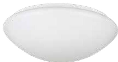
CRXG ist eine runde opale Decken- und Wandanbauleuchte mit tiefgezogenem, verwindungssteifem Stahlblechunterteil und fein strukturierter opaler Acrylglas-Wanne mit wirkungsvollem Mattdekor. Federverschlüsse sorgen für sicheren Halt der Wanne. Die Leuchte kann in drei verschiedenen Größen geliefert werden. Durch hochwertige LED-Module verfügen die LED-Varianten über eine Lebensdauer von bis zu 50.000 Stunden (L70).
